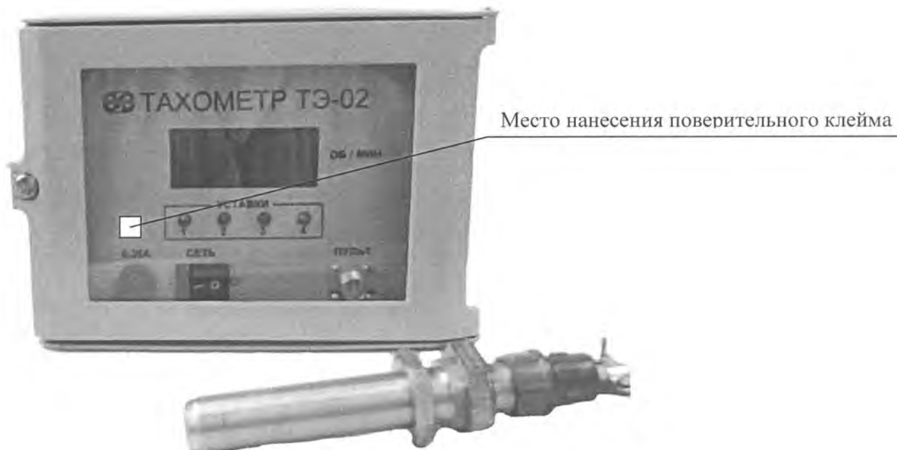
Рисунок А.1 - Схема нанесения на тахометр знака поверки
