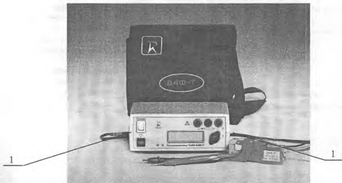
Рисунок 1 – Внешний вид и схема пломбирования от несанкционированного доступа (1 – Место для нанесения оттиска клейм)
