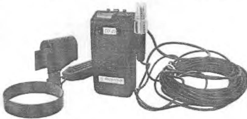
Фото 3 – Внешний вид сигнализаторов СГГ-20-03К с БД на кабеле длиной 1,5 м с приспособлением для контроля содержания горючих газов и паров в баллонах
