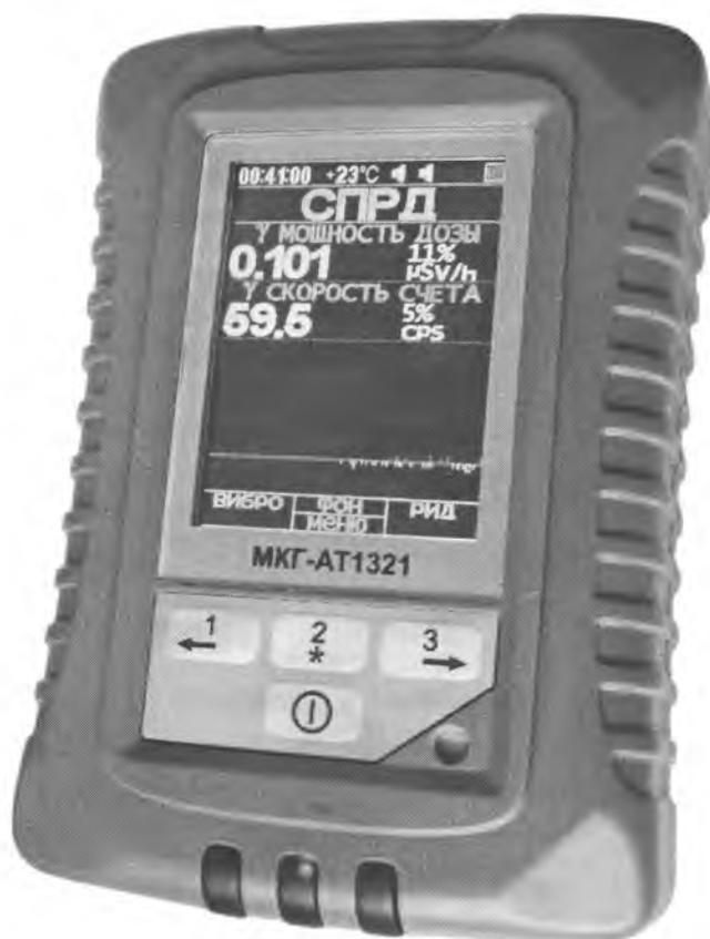
Рисунок 1 – Общий вид спектрометра МКГ-АТ1321
