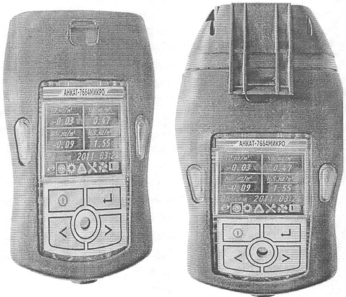
а) б) Рисунок 2 - Внешний вид газоанализатора: а) - без побудителя расхода; б) - с побудителем расхода
