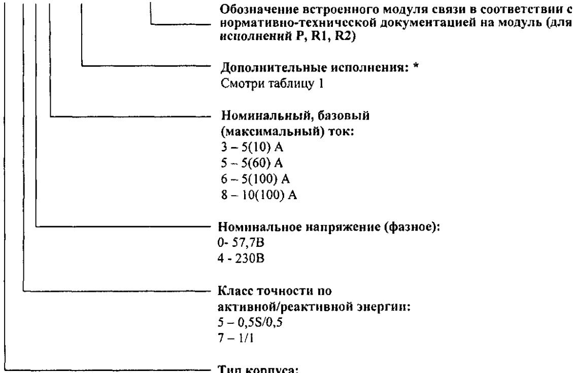
Примечание - \* Количество символов определяется наличием дополнительных программно-аппаратных опций в соответствии с таблицей 1.
