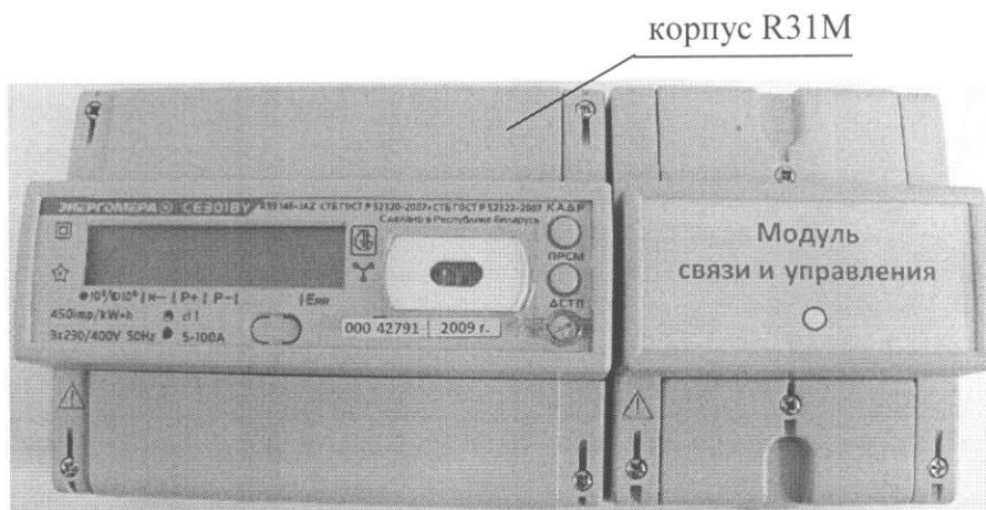
Рисунок 2 – Внешний вид счетчиков электрической энергии CE301BY, корпус R
