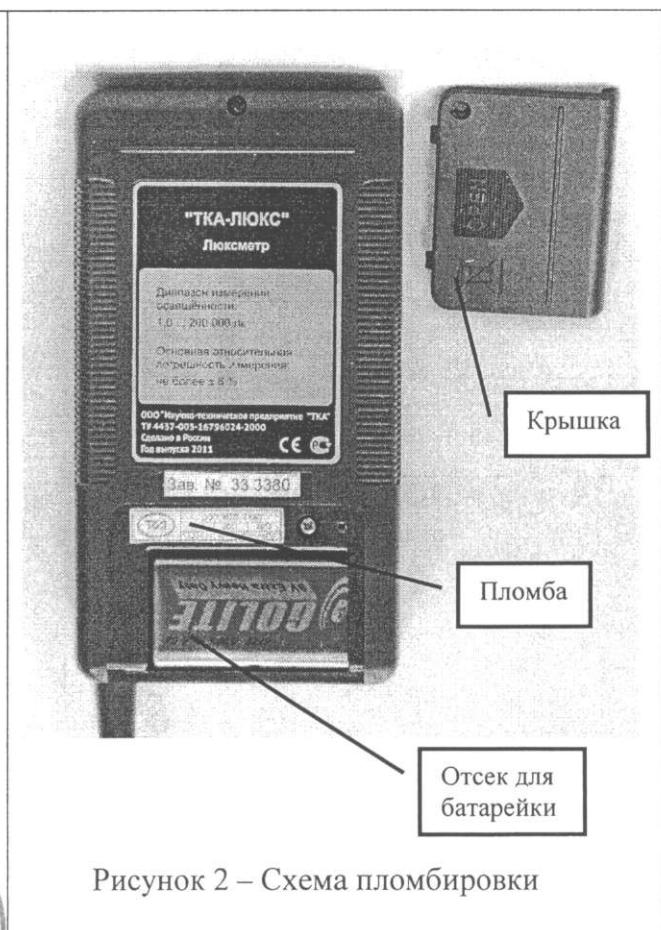
Рисунок 2 – Схема пломбировки
