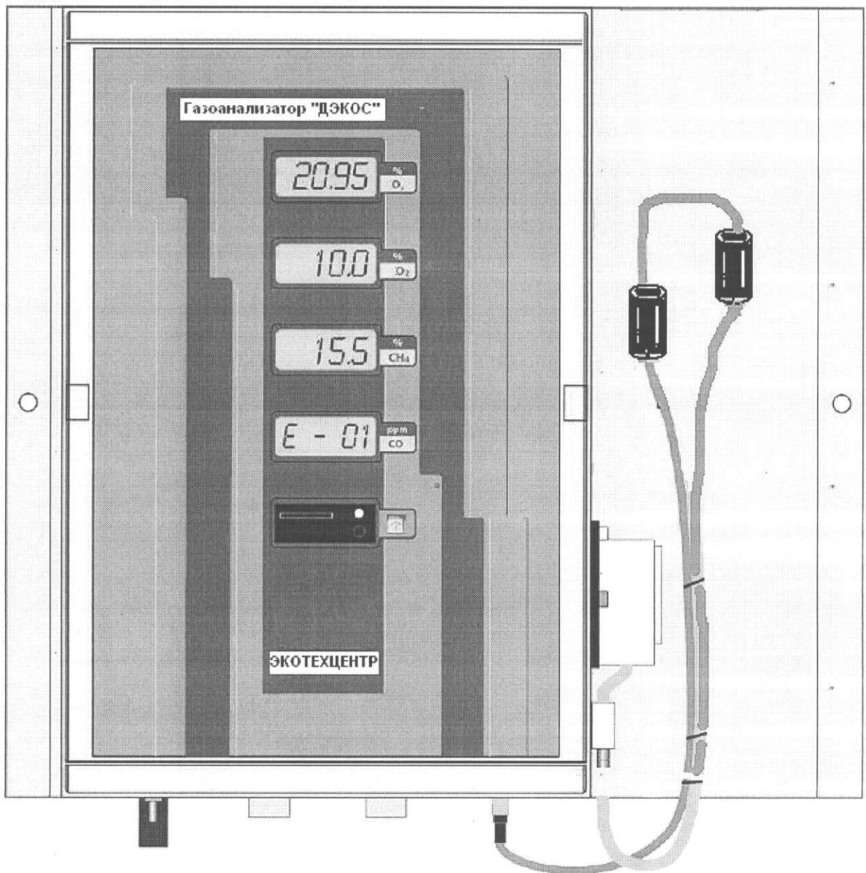
Рисунок 1 Внешний вид газоанализатора ДЭКОС
