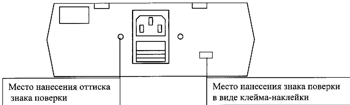
Рисунок А.1 – Схема с указанием места нанесения знака поверки в виде клейма-наклейки и оттиска знака поверки на задней панели вольтметров.
