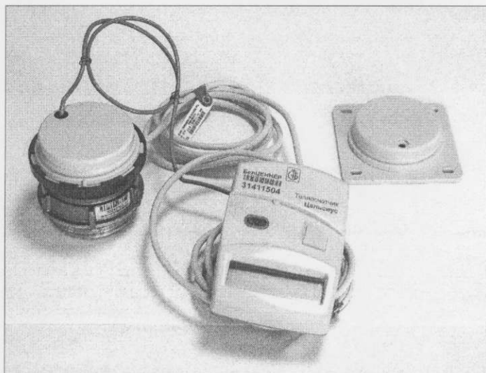
Рисунок 2. Теплосчетчик в исполнении «Сплит».
