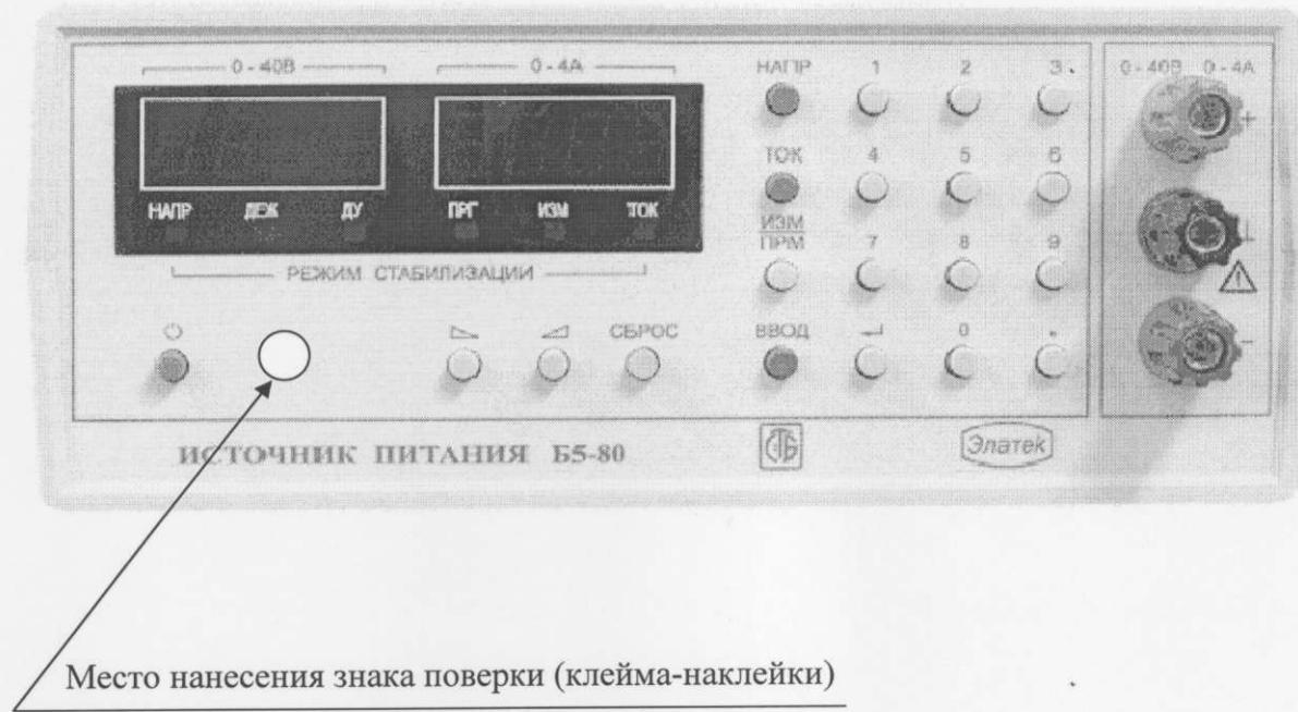
Рисунок А.1 Место нанесения знака поверки (клейма-наклейки)
