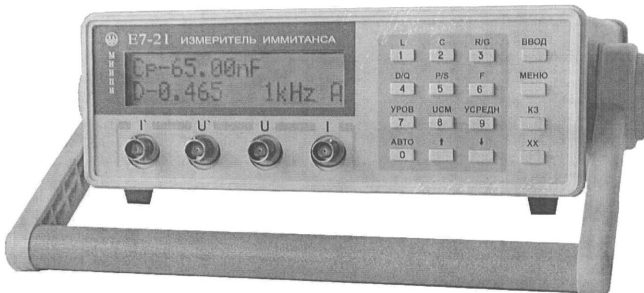
Рисунок 1 - Измеритель иммитанса E7-21. Внешний вид
