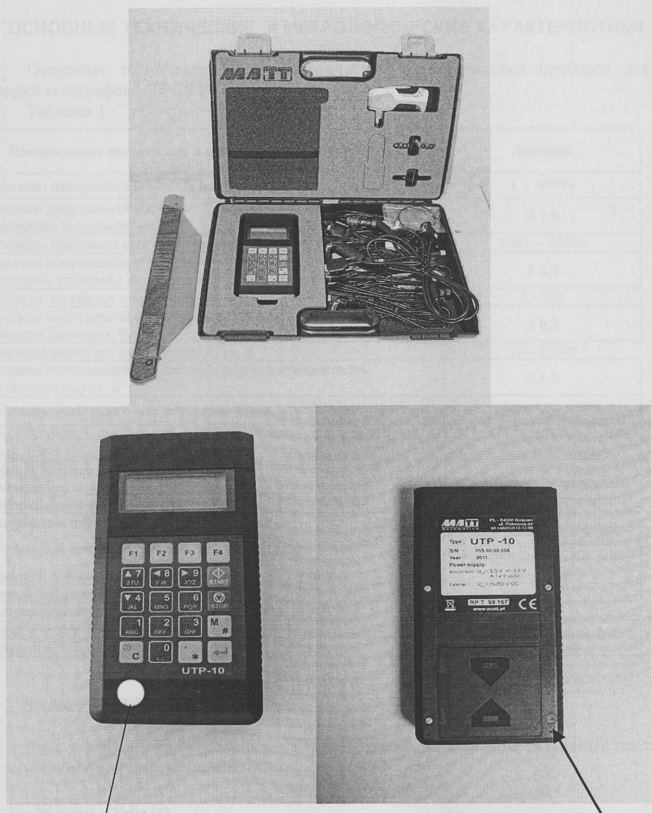
Рисунок 1. Внешний вид приборов для поверки тахографов UTP-10 BY, место нанесения знака поверки в виде клейма-наклейки, место пломбировки от несанкционированного доступа
