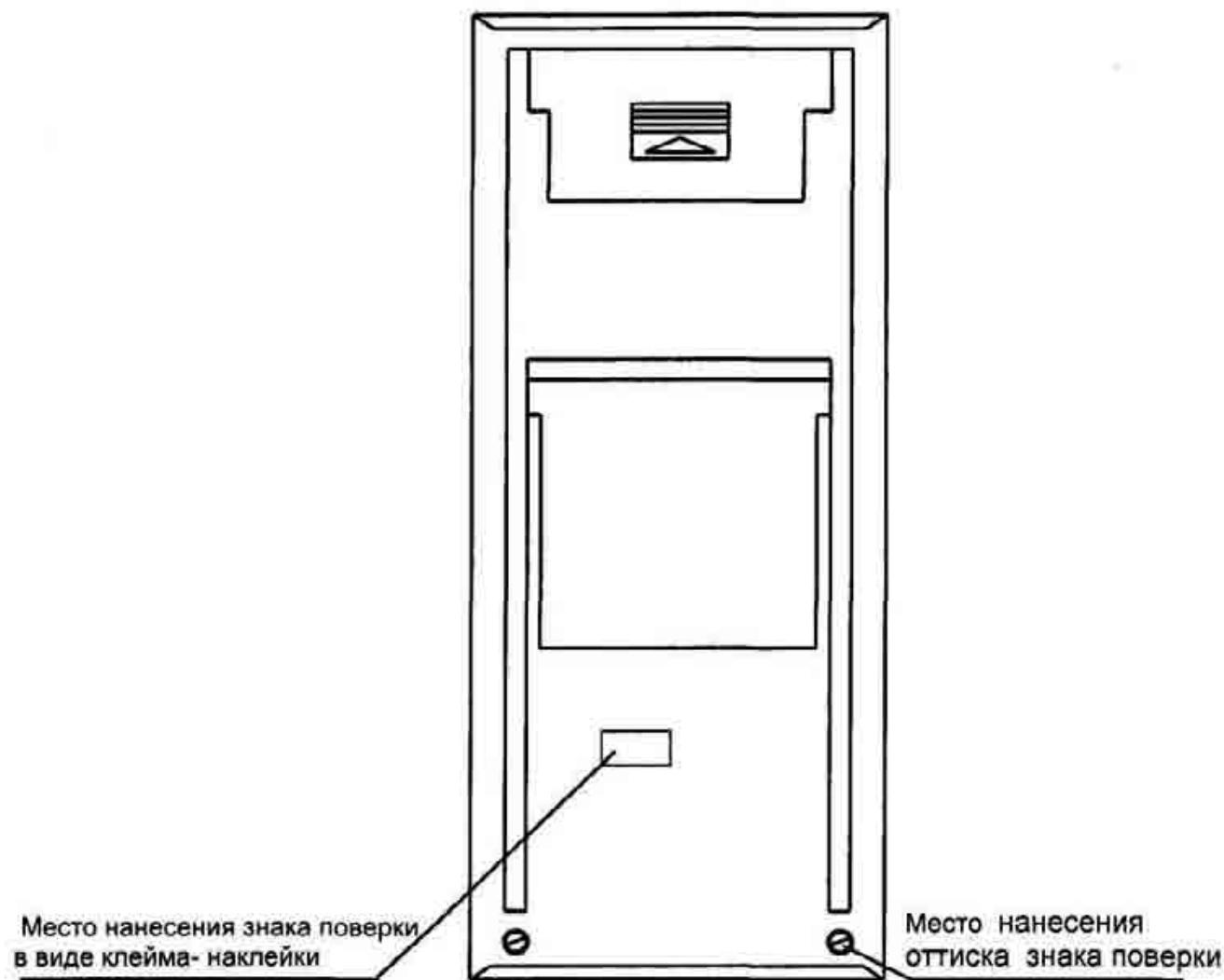
Рисунок А.1 – Место нанесения оттиска знака поверки и знака поверки в виде клейма- наклейки на основании мультиметров
