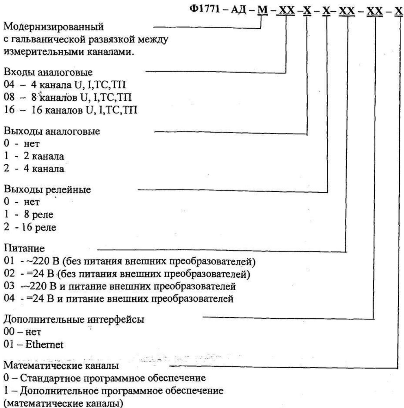
Примечание: для исполнений прибора без гальванической развязки буква «М» в обозначении не указывается.
