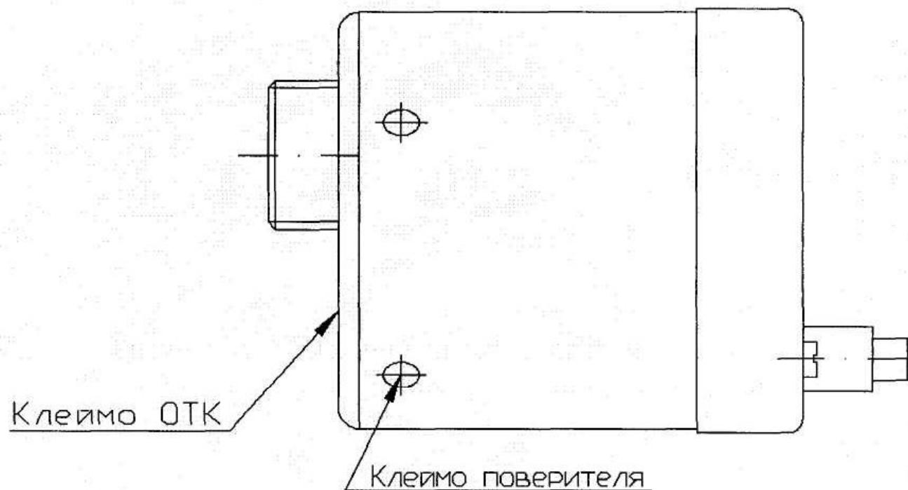
Рисунок А.2 – Схема клеймения вольтамперметра ВА-040.
