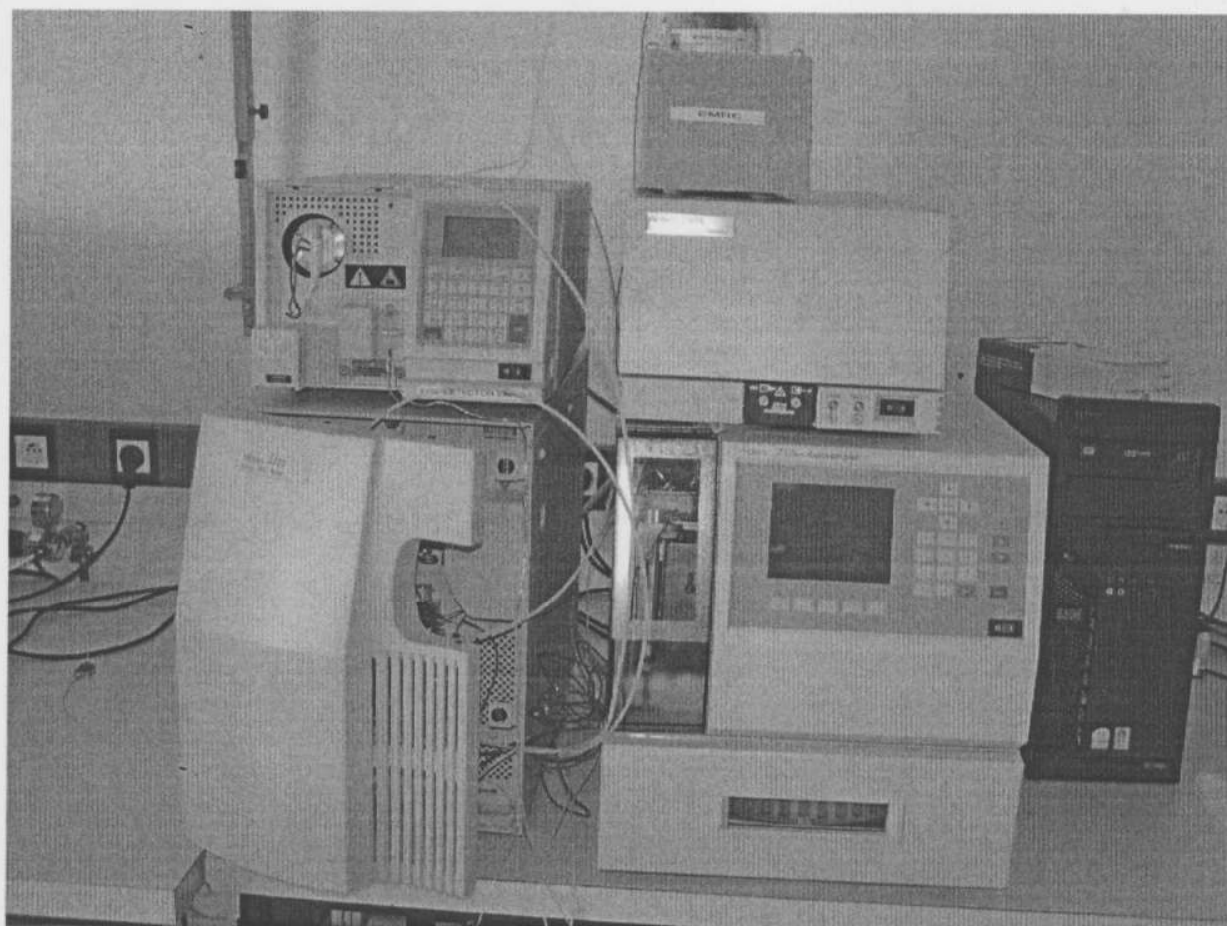
Рисунок 2 – автосамплер 717, градиентный насос 1525, диодно-матричный детектор 2998, флуоресцентный детектор 2475
