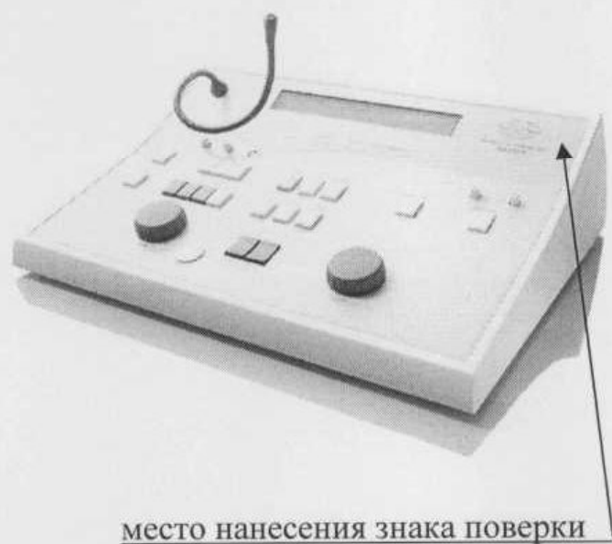
Рисунок 3 - Место нанесения знака поверки в виде клейма-наклейки на аудиометр AD229
