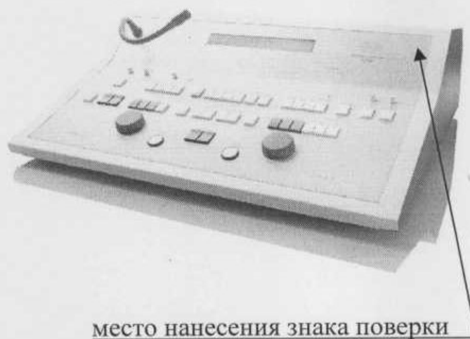
Рисунок 2 - Место нанесения знака поверки в виде клейма-наклейки на аудиометр АС33
