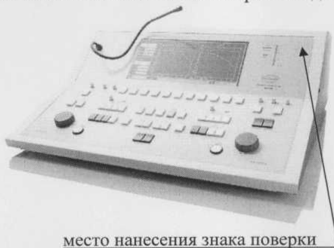
Рисунок 1 - Место нанесения знака поверки в виде клейма-наклейки на аудиометр АС40
