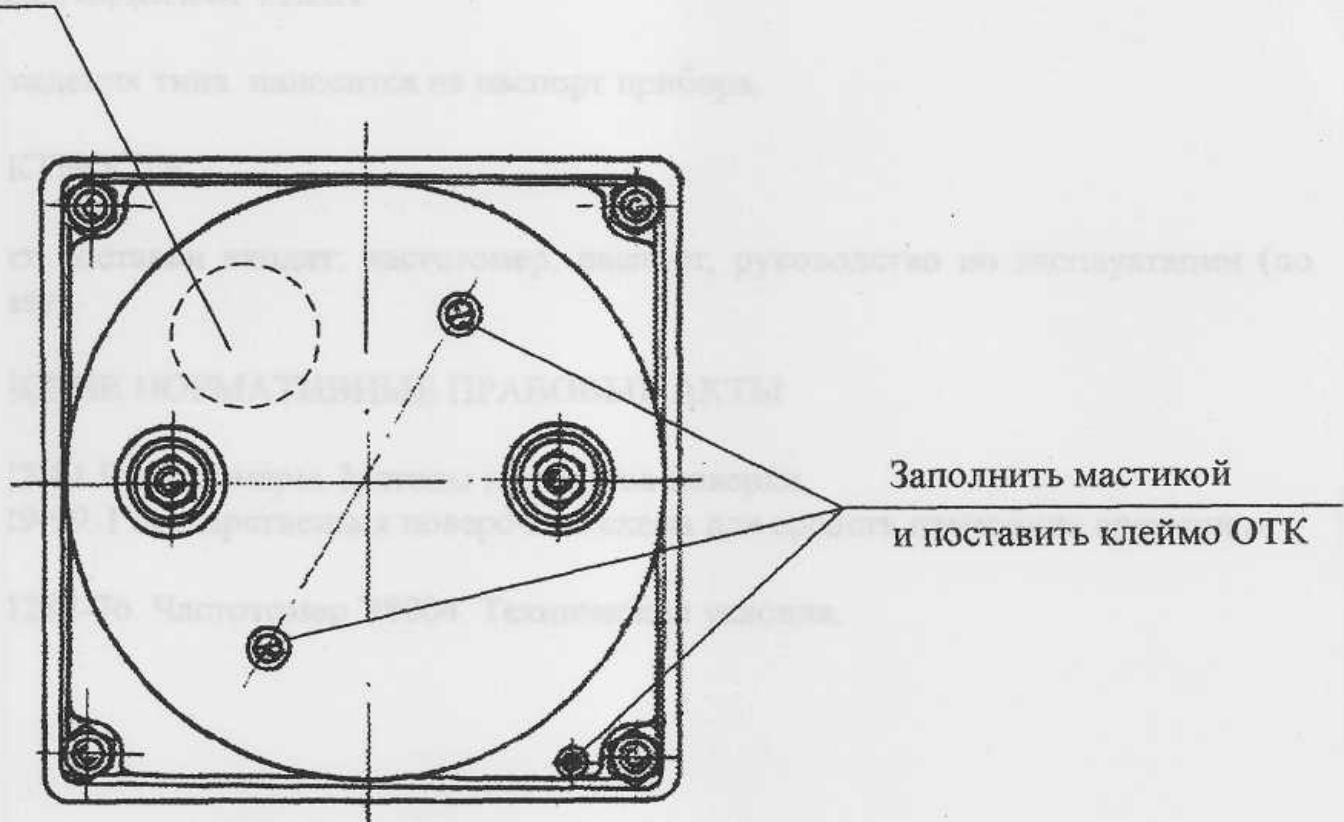
Рисунок 2 – Схема клеймения частотомера.
