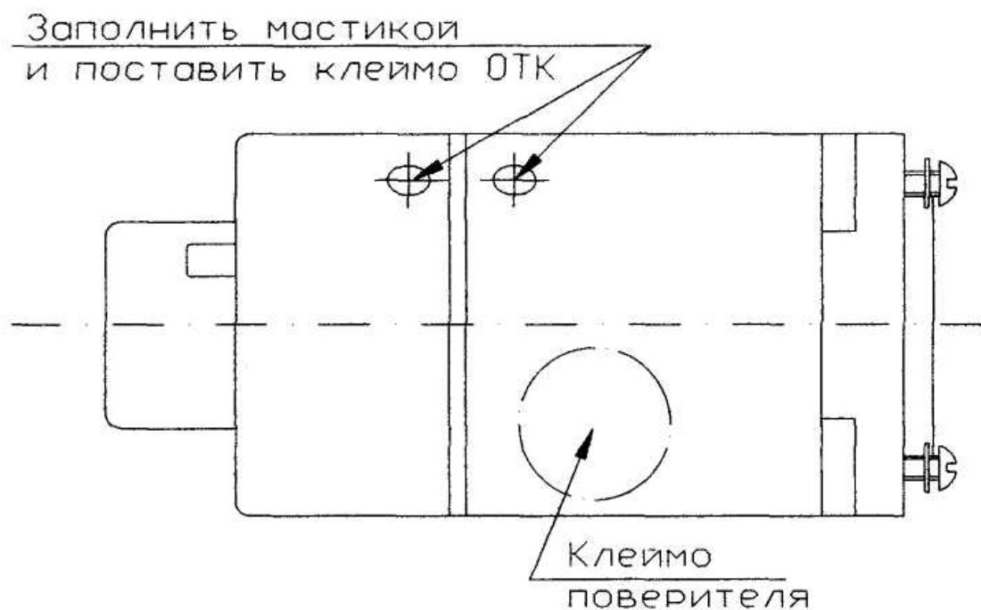
Рисунок 2 – Схема клеймения амперметра.
