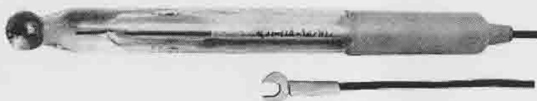
Рисунок 1 – Общий вид электродов стеклянных промышленных ЭСП-01-14, ЭСП-04-14
