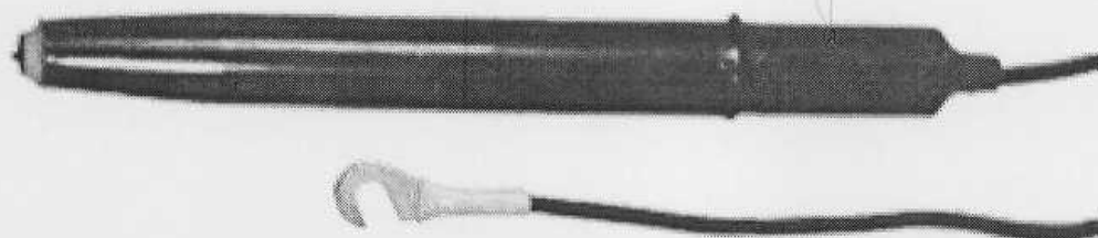
Рисунок 1 – Общий вид электродов мембранных ЭМ-I-01, ЭМ-CN-01
