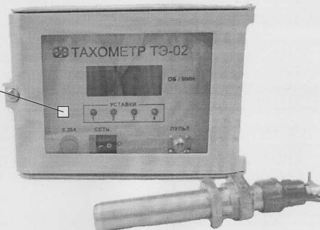
Рисунок А.1 - Схема нанесения на тахометр знака поверки
