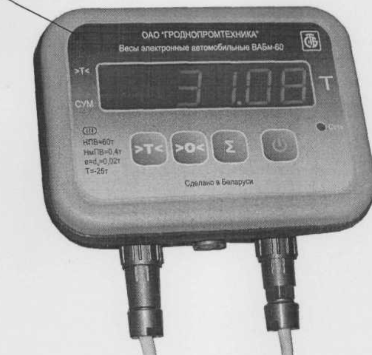
Рисунок А2 - Место расположения знака поверки на весах (дискретное отсчетное устройство – вид спереди)
