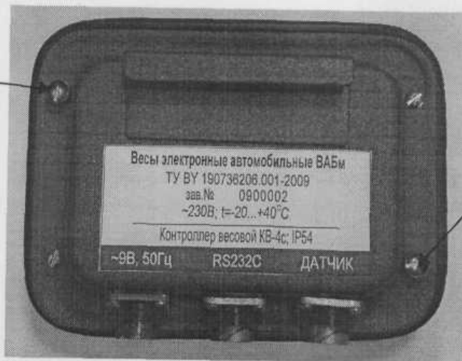
Рисунок А1 - Схема пломбирования весов (дискретное отсчетное устройство – вид сзади)
