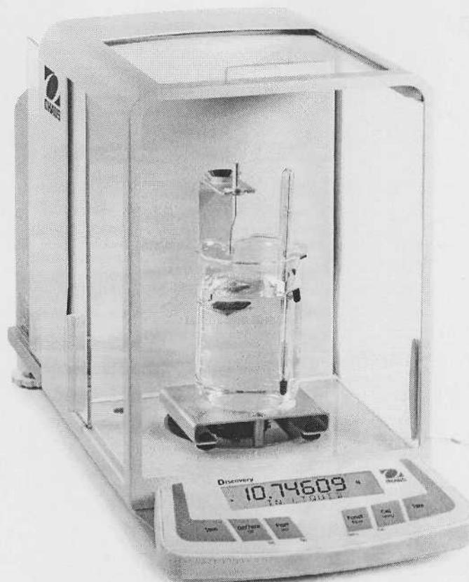
Рисунок 1 Внешний вид весов лабораторных электронных DV (Discovery)
