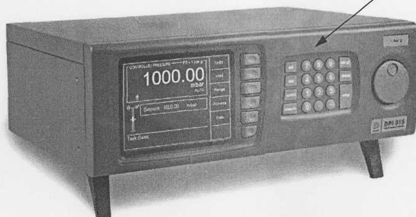
Рисунок А.1. Место нанесения знака поверки в виде клейма-наклейки
