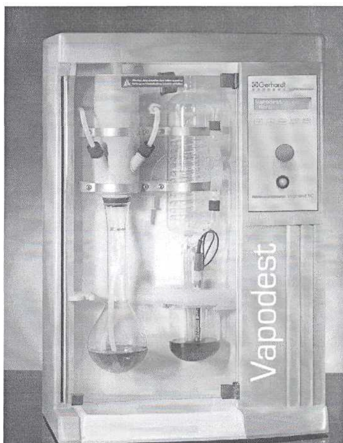
Рисунок 1 Система дистилляционная автоматическая Vapodest 50s со встроенным титратором.
