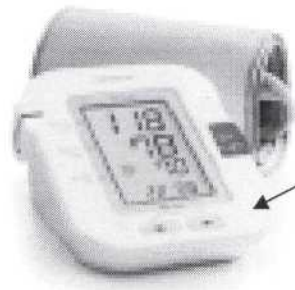
Рисунок А.2 Внешний вид измерителя М6 Comfort/HEM-7000-E и место нанесения поверительного клейма-наклейки
