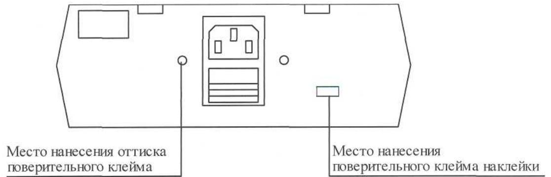
Рисунок А.1 – Место нанесения отиска поверительного клейма и поверительного клейма наклейки на задней панели вольтметров
