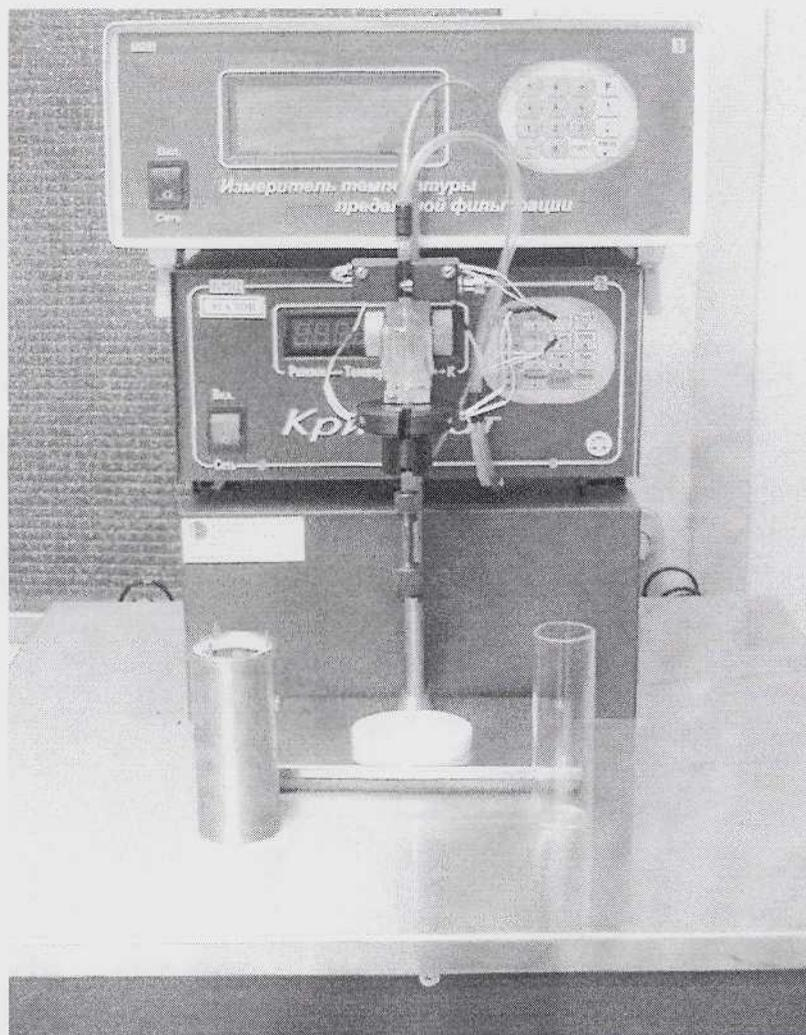
Рис. 1 Внешний вид измерителя предельной температуры фильтруемости нефтепродуктов автоматического ИТФ.
