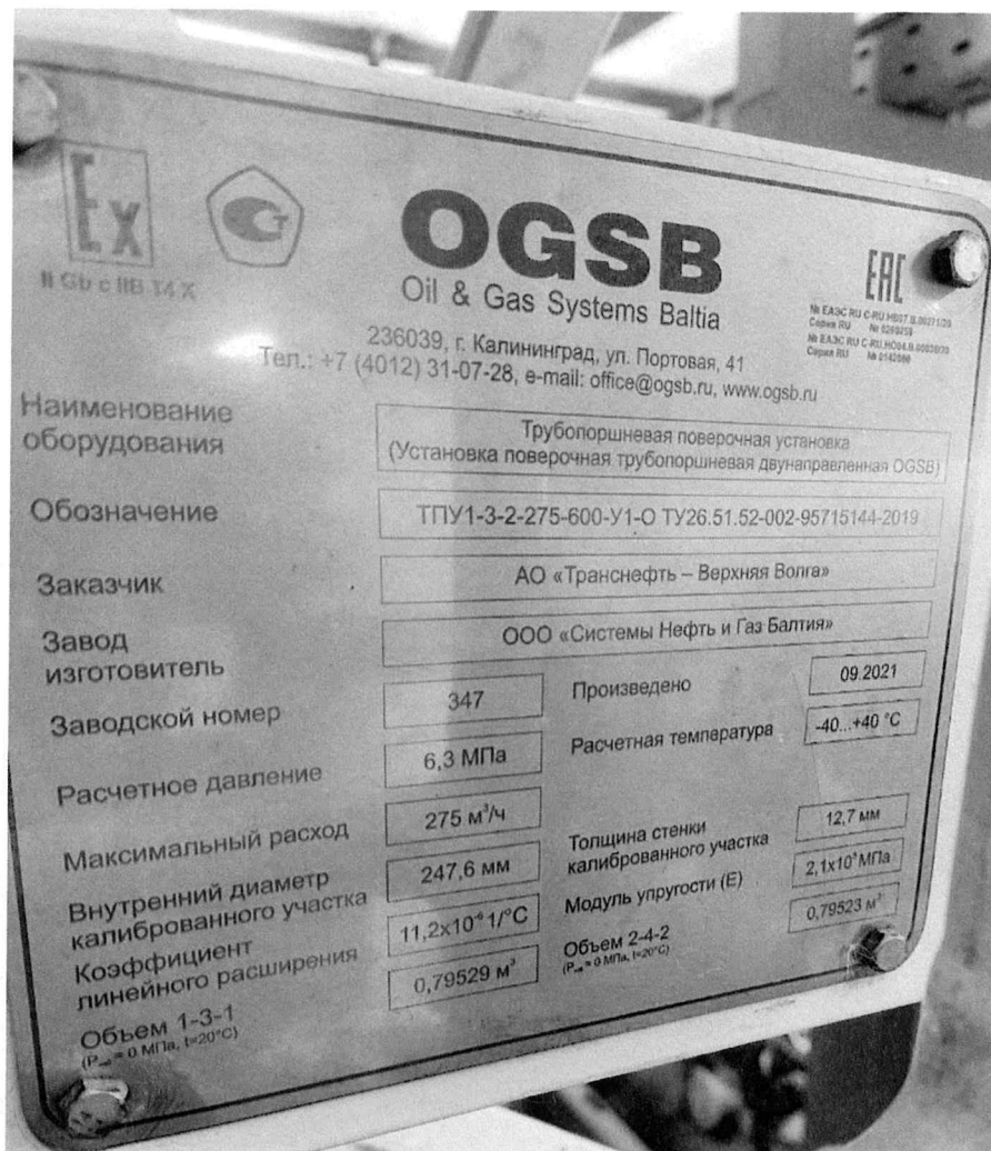
Рисунок 1.3 – Фотография маркировки трубопоршневой поверочной установки двунаправленной OGSB № 347
