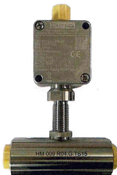
Рисунок 1.6 – Фотография расходомера турбинного НМ с преобразователем ЕСО-К1-РН-АР из состава системы
