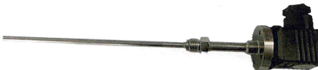
Рисунок 1.7 – Фотография термопреобразователя сопротивления ТС-Б-Pt100 из состава системы
