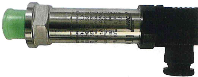
Рисунок 1.8 – Фотография датчика давления ИД-Г-И из состава системы
