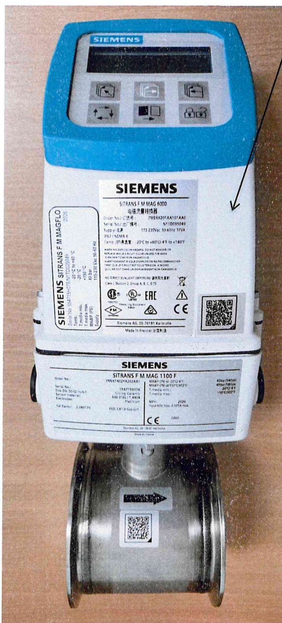
Рисунок 2.1 Схема (рисунок) с указанием места для нанесения знака поверки расходомера электромагнитного SITRANS F M MAGFLO № 554715H076/N1TD035049
