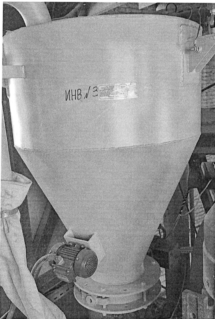
Рисунок 1.1 – Фотография внешнего вида дозатора весового дискретного действия для дозирования цемента типа ДВДДц № 002
