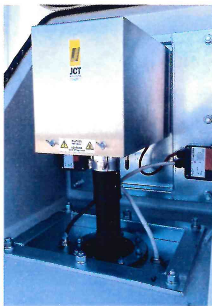
Рисунок 1.3 – Общий вид пробоотборного зонда JES301E1BOS Ex
