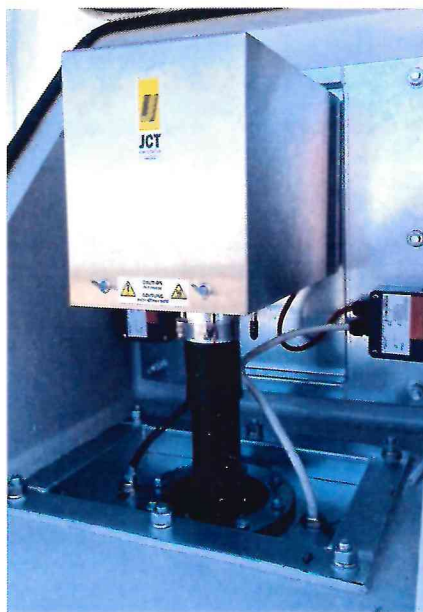
Рисунок 1.3 – Общий вид пробоотборного зонда JES-301
