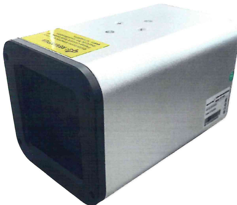
Рисунок 1.1 – Фотография общего вида абсолютно черного тела DIVITEC DT-TH01, № S12312260200840002
