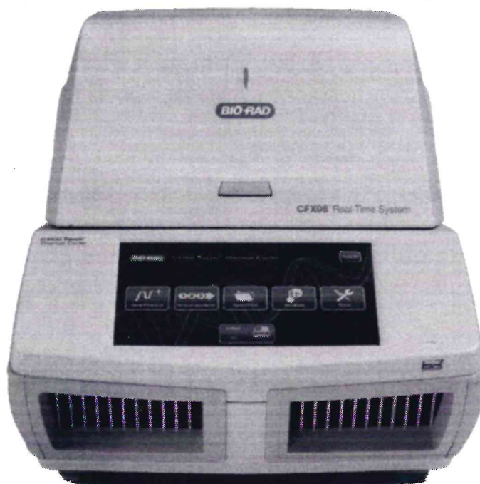
Рисунок 1.1 – Фотография общего вида термоциклера для амплификации нуклеиновых кислот модель C1000 Touch Thermal Cycler с модулем оптическим реакционным CFX96 № CT059725 / 785BR31890
