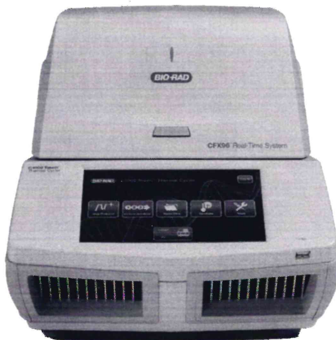
Рисунок 1.1 – Фотография общего вида термоциклера для амплификации нуклеиновых кислот модель C1000 Touch Thermal Cycler с модулем оптическим реакционным CFX96 № CT068904 / 785BR33930
