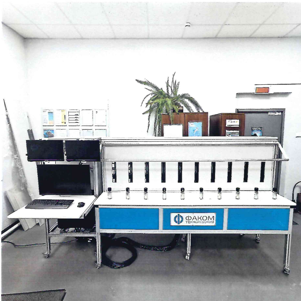
Рисунок 1.1 – Фотография общего вида установки автоматизированной поверки манометров «Поток-М», № 015
