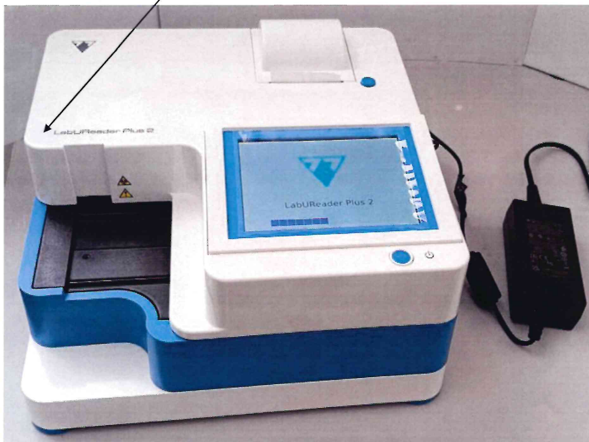
Рисунок 2.1 – Схема с указанием места для нанесения знака поверки на анализатор мочи LabUReader Plus 2 № UA301001409
