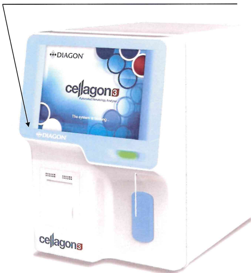
Рисунок 2.1 – Схема с указанием места для нанесения знака поверки на анализатор гематологический автоматический Cellagon 3 № 300000248
