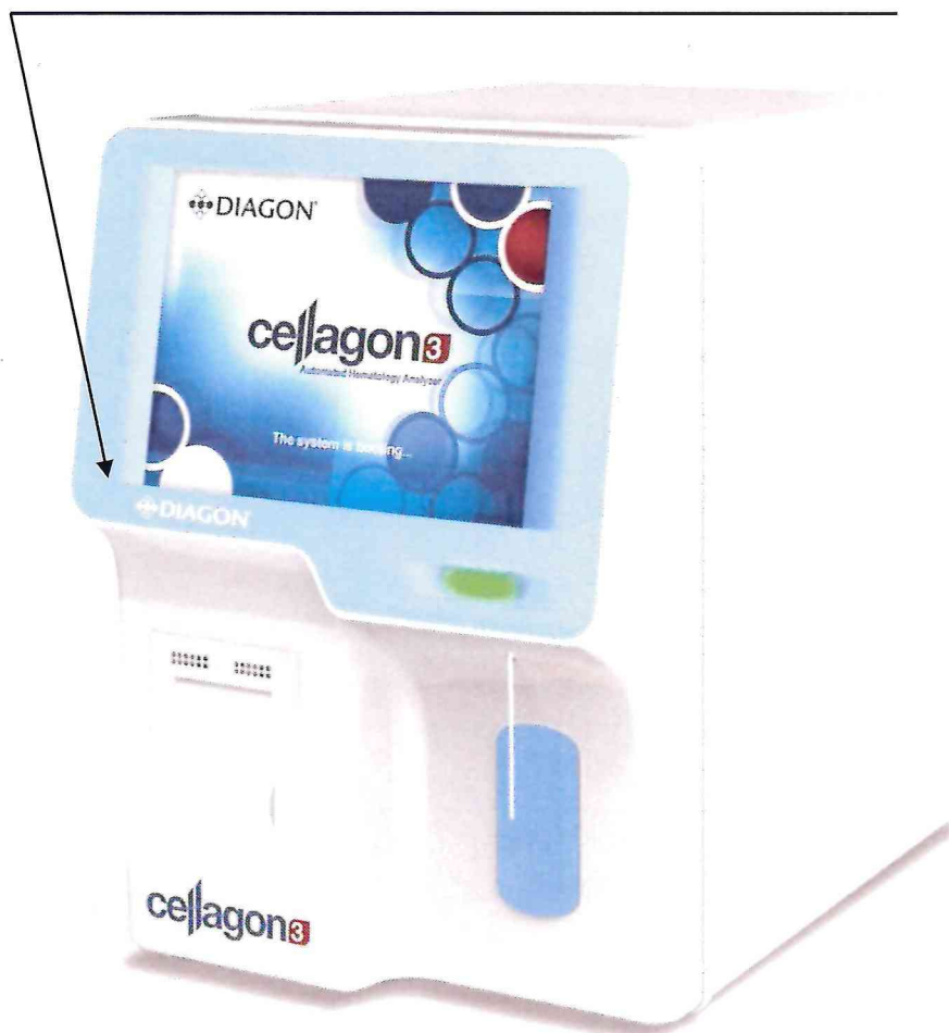
Рисунок 2.1 – Схема с указанием места для нанесения знака поверки на анализатор гематологический автоматический Cellagon 3 № 30000192
