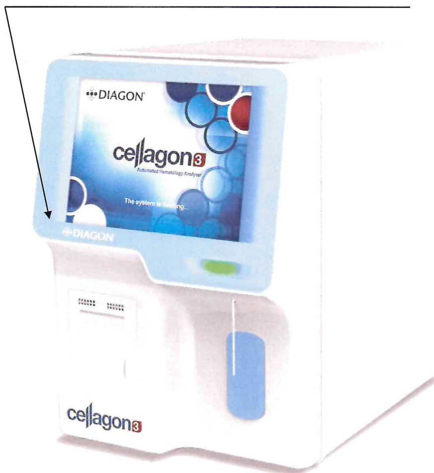
Рисунок 2.1 – Схема с указанием места для нанесения знака поверки на анализатор гематологический автоматический Cellagon 3 № 30000194
