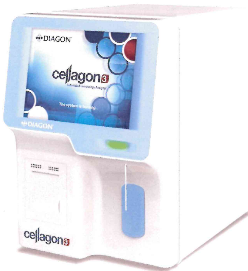
Рисунок 1.1 – Фотография общего вида анализатора гематологического автоматического Cellagon 3 № 300000277
