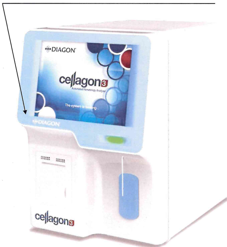
Рисунок 2.1 – Схема с указанием места для нанесения знака поверки на анализатор гематологический автоматический Cellagon 3 № 300000277
