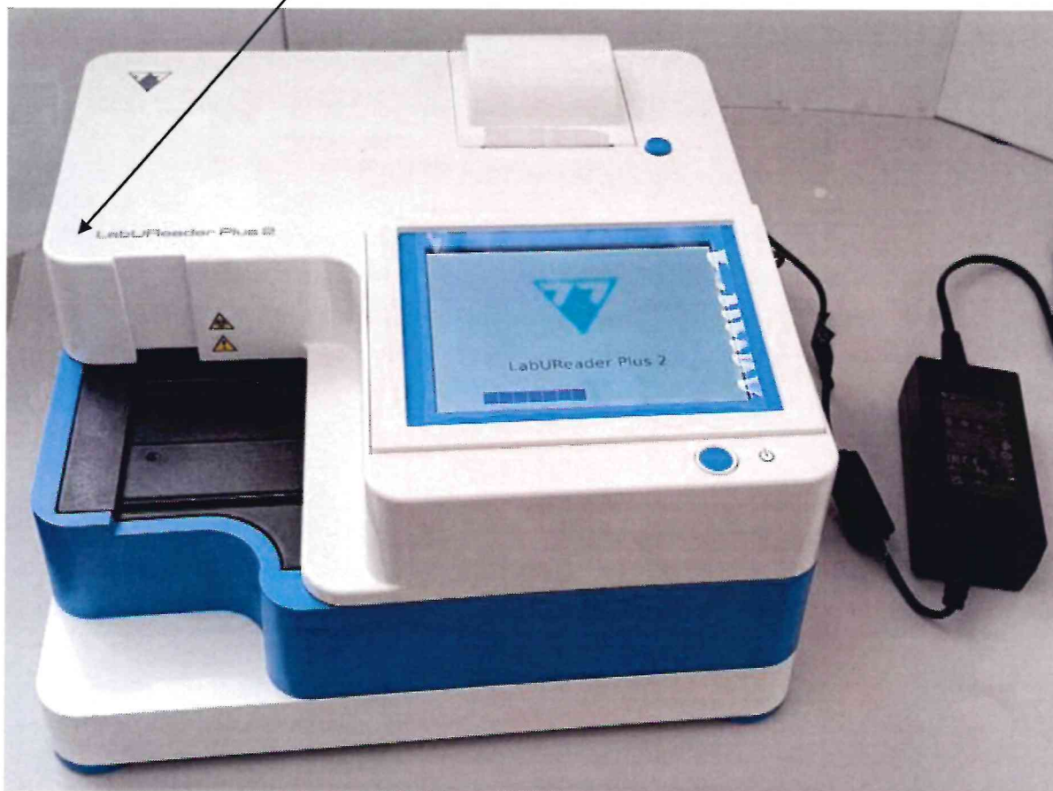
Рисунок 2.1 – Схема с указанием места для нанесения знака поверки на анализатор мочи LabUReader Plus 2 № UA301001394
