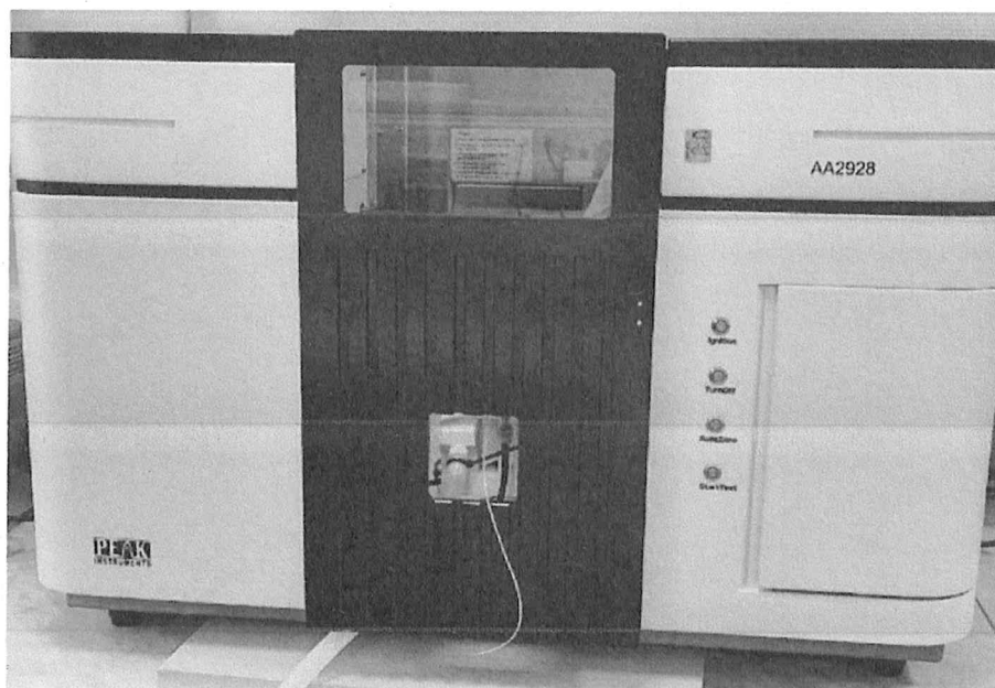
Рисунок 1.1 – Фотография общего вида средства измерений (Атомно-абсорбционный спектрофотометр AA2928 зав.№ PK25202412127)
