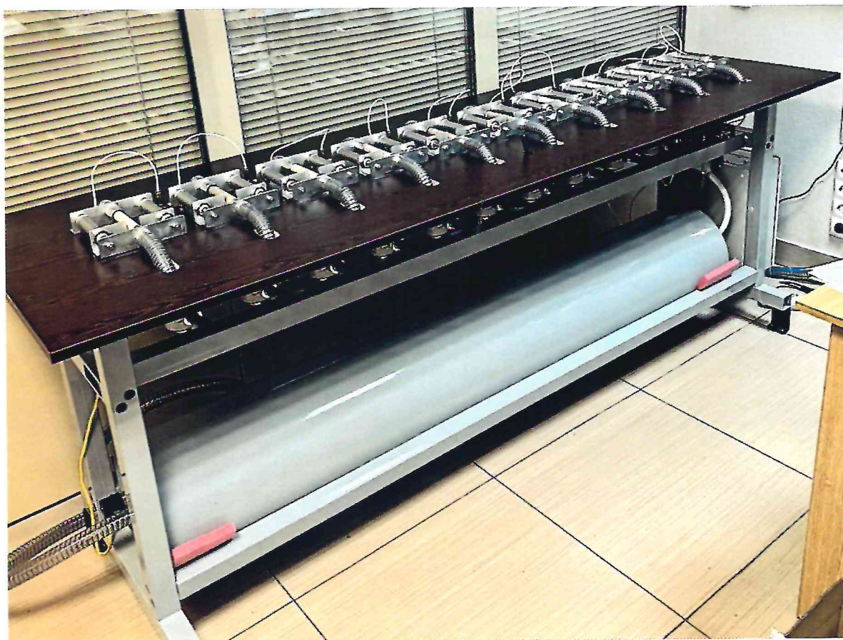
Рисунок 1.1 – Фотография общего вида установки поверочной для счетчиков газа УПКСГ-10, № 023
