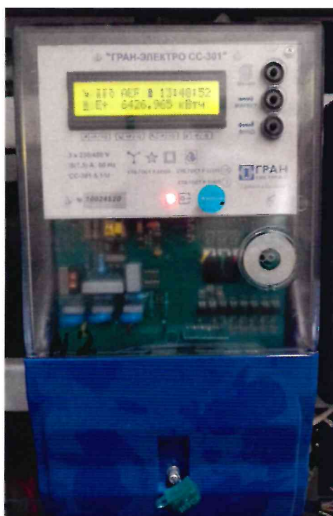
Рисунок 1.2 – Фотографии счётчиков, входящих в состав измерительных каналов АСКУЭ (изображения носят иллюстративный характер)
